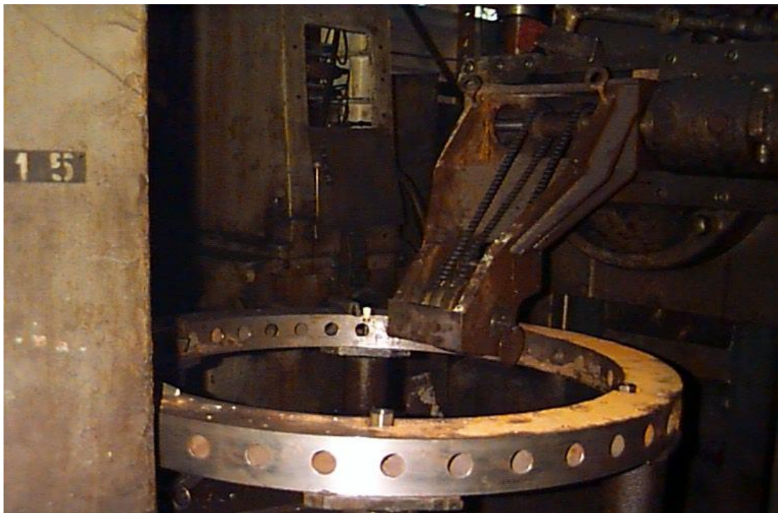
5.2. ábra. A hordócsiga megmunkálása
