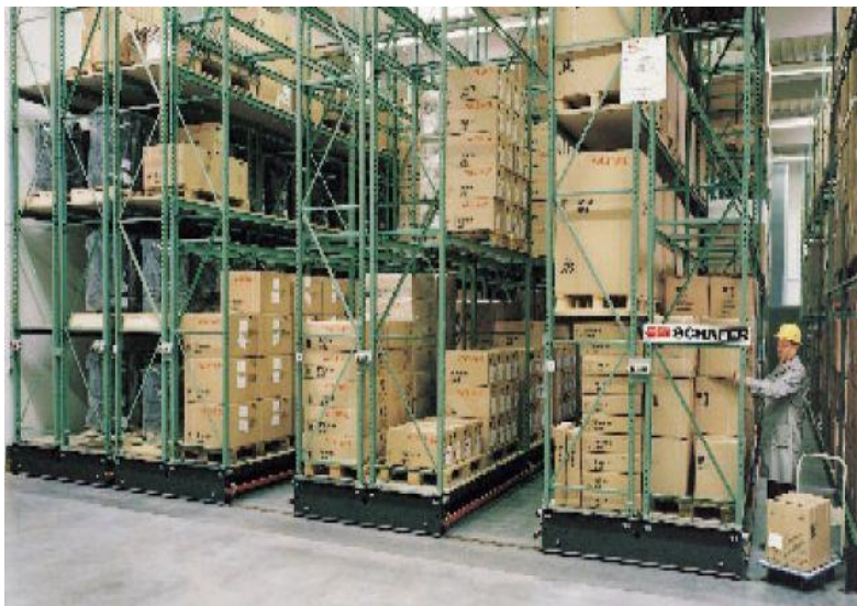
32. ábra. Folyamatos töltési és ürítési rendszer kialakítása eltolható állványos tárolás esetén
