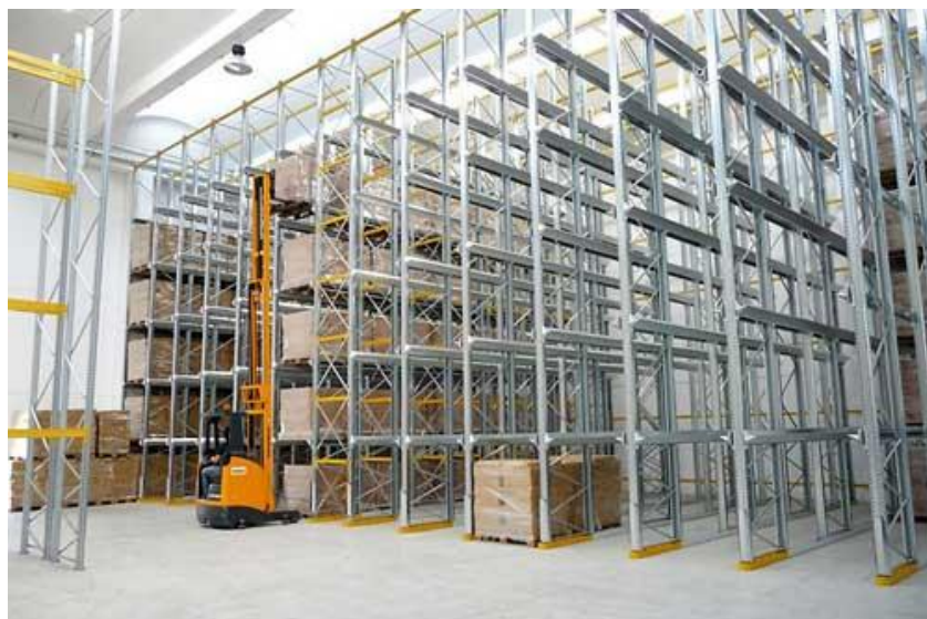
23. ábra. Átjárható állványos tárolási rendszer üres polcokkal
