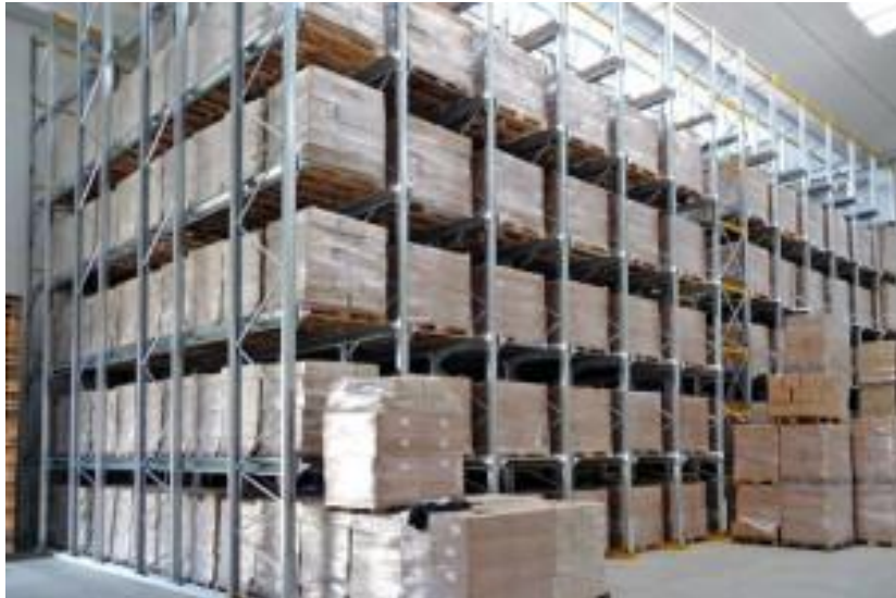
24. ábra. Átjárható állványos tárolási rendszer tele polcokkal
