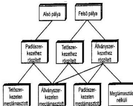
102. ábra. A pályaelhelyezés és rögzítés módjai
