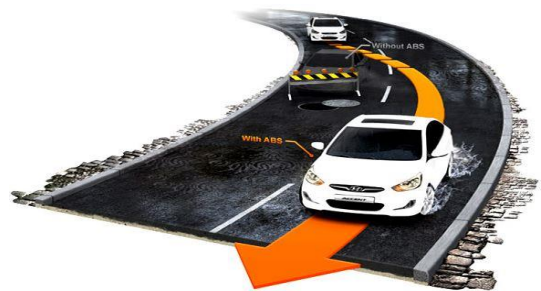
3.13. Az ABS lehetővé teszi a fékezés alatti elkörmányzást
