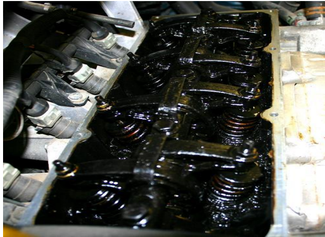
3. ábra. A nem megfelelő időben végzett olajcsere következményei [4]
