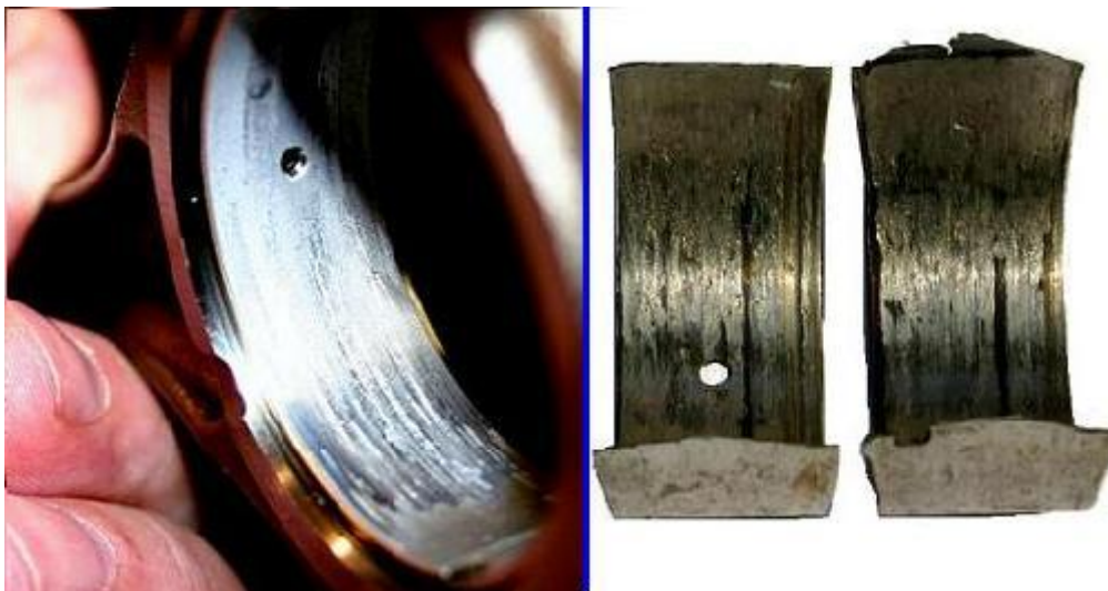
4. ábra Szemmel láthatóan sérült, selejt csapágycsésze [4]
