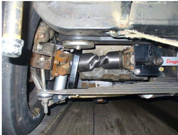
2. ábra alulméretezett „tuning” féltengely
