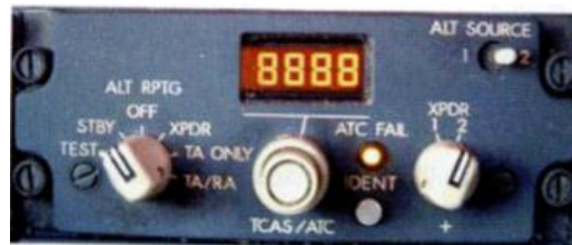
74. ábra: Transzponder LCD kijelzője Forrás: [1], 5-9.p.
