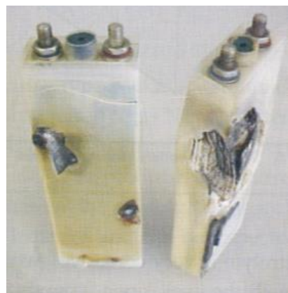
39. ábra: Hőinstabilitás következménye Forrás: [1], 3-6.p.
